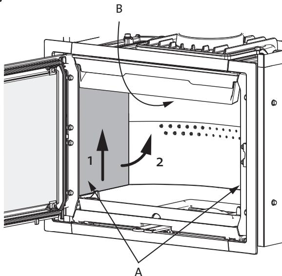
2. Rimuovere la piastra refrattaria laterale (A) sollevandola leggermente e sostenendo intanto il parafiamma (B). Tirare fuori la piastra refrattaria laterale sul fondo ed estrarla. Dopodiché, rimuovere l'altra piastra refrattaria laterale allo stesso modo.
