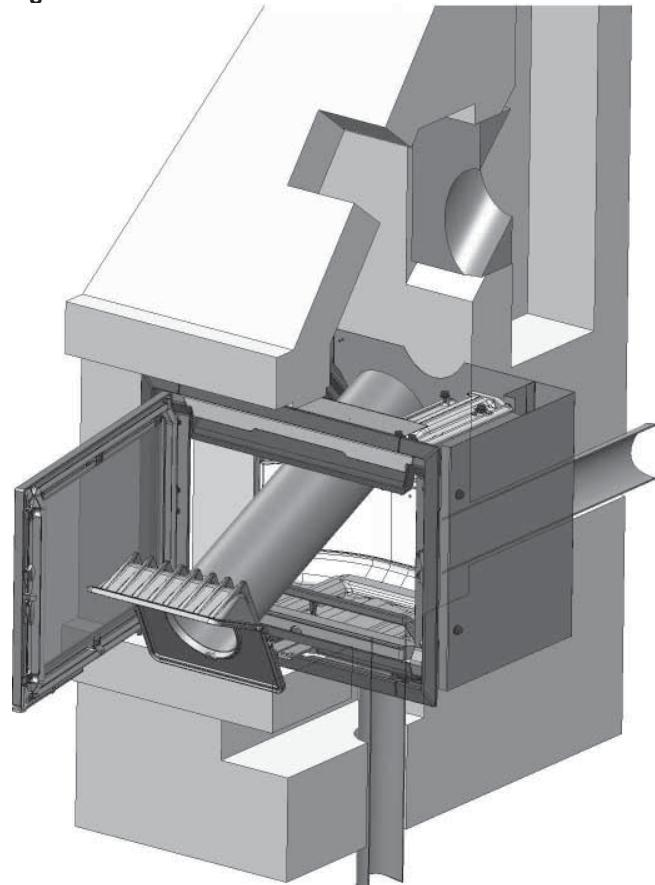
5. Sujete la campana de humos (A) al borde del tubo de chimenea equipado con la junta.
