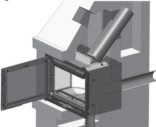
8. Si instala el hogar como muestra el ejemplo 3, le recomendamos que introduzca el tubo de chimenea por la abertura de la puerta de la cámara de combustión. Introduzca el tubo de chimenea con la campana de humos por la abertura de la puerta y hágalo pasar por el orificio para la campana de humos y el material aislante de manera que salga a la chimenea.
