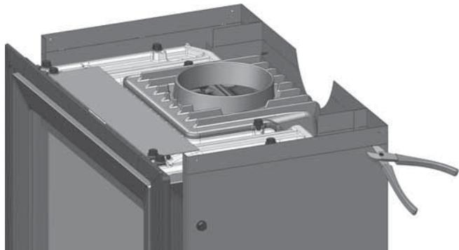
1. Corte por la línea de puntos la parte superior de la pantalla térmica y quite la sección cortada.
