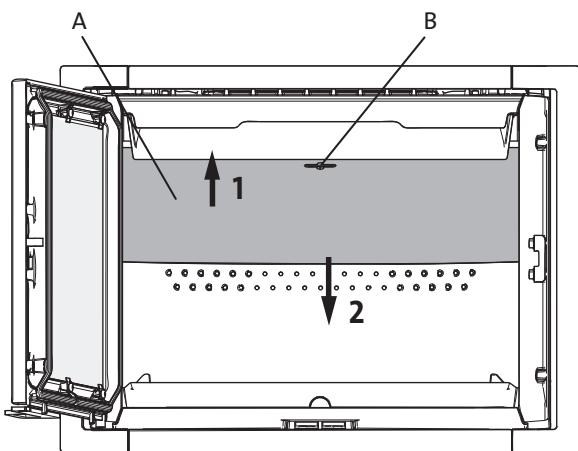
3. Empuje hacia arriba la placa deflectora (**A**). Gire la llave (**B**) 90° y extrágala. Tire hacia abajo del borde de la placa deflectora.
