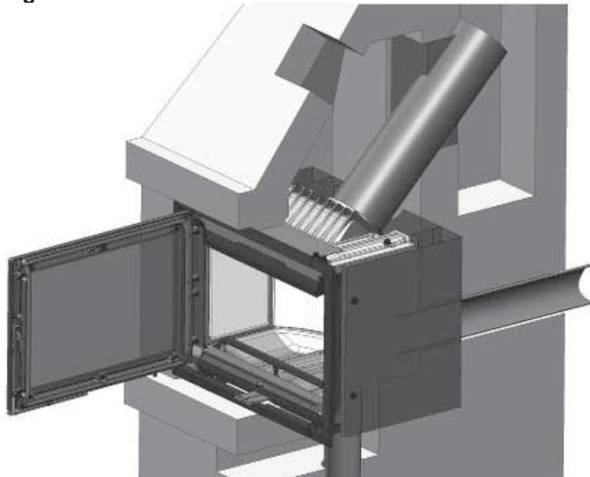
8. Si le montage s'effectue comme indiqué dans l'exemple 3, nous recommandons de visser le conduit de fumée par l'ouverture de la porte de la chambre de combustion. Poussez le conduit de raccordement avec la buse de raccordement à travers l'ouverture dans la porte et l'ouverture de la buse de raccordement et un matériau isolant et à l'intérieur de la cheminée.
