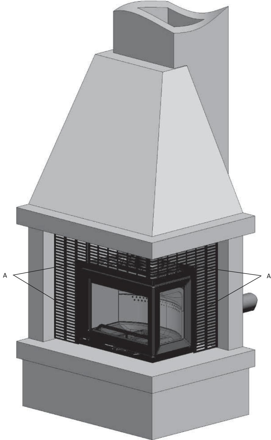
La grille métallique (**A**) doit être découpée pour s'adapter à la cheminée. Voir le manuel séparé pour les instructions sur la façon d'intégrer les grilles en tôle.
