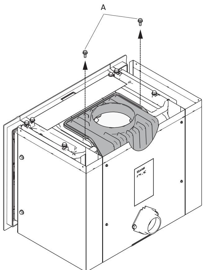
3. Rimuovere le due viti (**A**) che fissano la campana alla camera di combustione.
