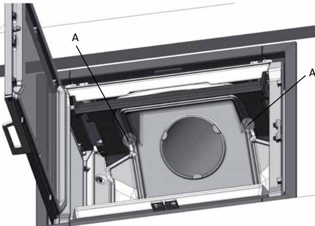
7. Fixez ensuite buse de raccordement à l'aide des vis (**A**) qui avaient été retirées lors de sa dépose de la sortie par le haut.
