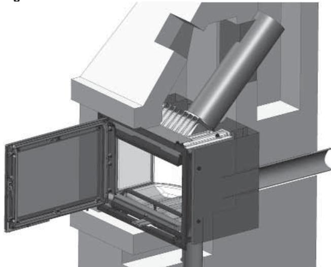
8. Se l'installazione viene effettuata come da esempio 3, si raccomanda di inserire il condotto di scarico fumi attraverso l'apertura della porta della camera di combustione. Spingere il condotto di scarico fumi con sopra la campana attraverso l'apertura della porta e l'apertura per la campana ed eventuale materiale isolante e poi verso l'alto dentro alla canna fumaria.
