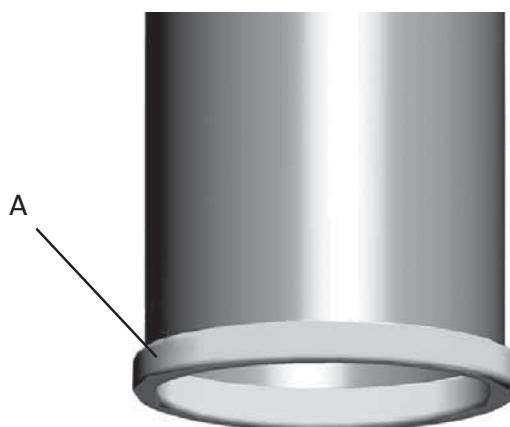
4. Coloque la junta (A) en el borde del tubo de chimenea.
