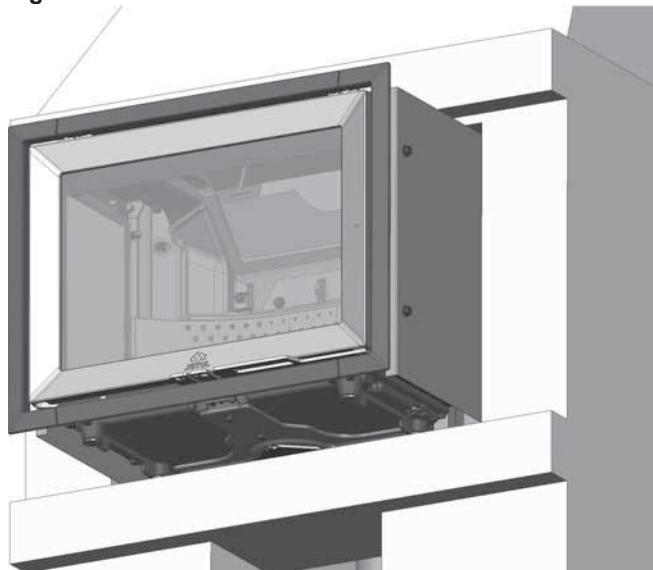
3. Deslice la cámara de combustión sobre los carriles moldeados de la parte inferior hasta que esté bien colocada en su lugar. Nivele la cámara de combustión como se indica en «Nivelación del hogar».
