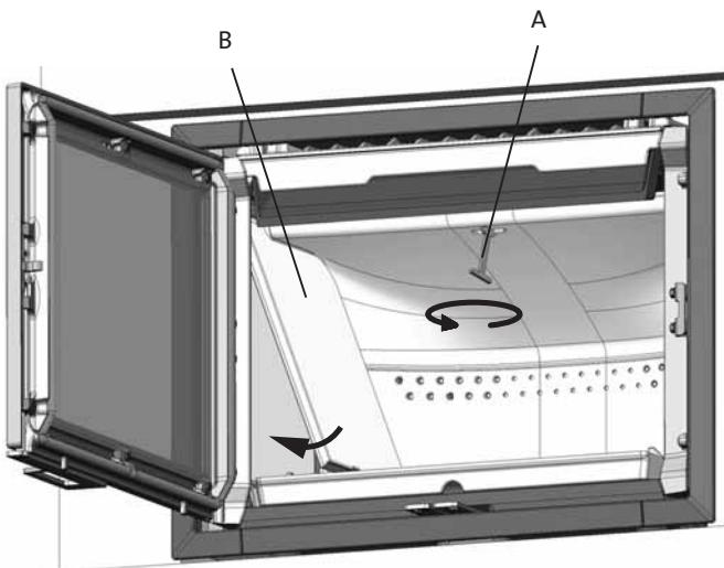
9. Empuje hacia arriba la llave (**A**) por el orificio de la placa deflectora, gírela y sujétela.
