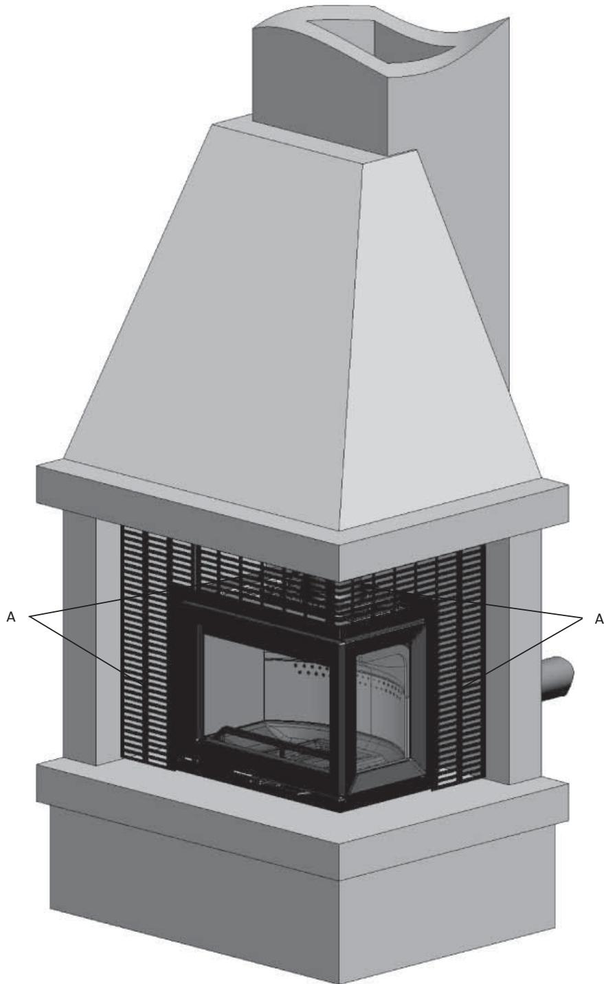
Corte la rejilla de chapa metálica (**A**) para ajustarla al hueco. Consulte en el manual correspondiente las instrucciones de instalación de la rejilla de chapa metálica.
