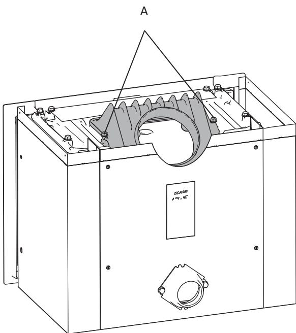
5. Avvitare nuovamente la campana sulla camera di combustione utilizzando le stesse due viti (A).
