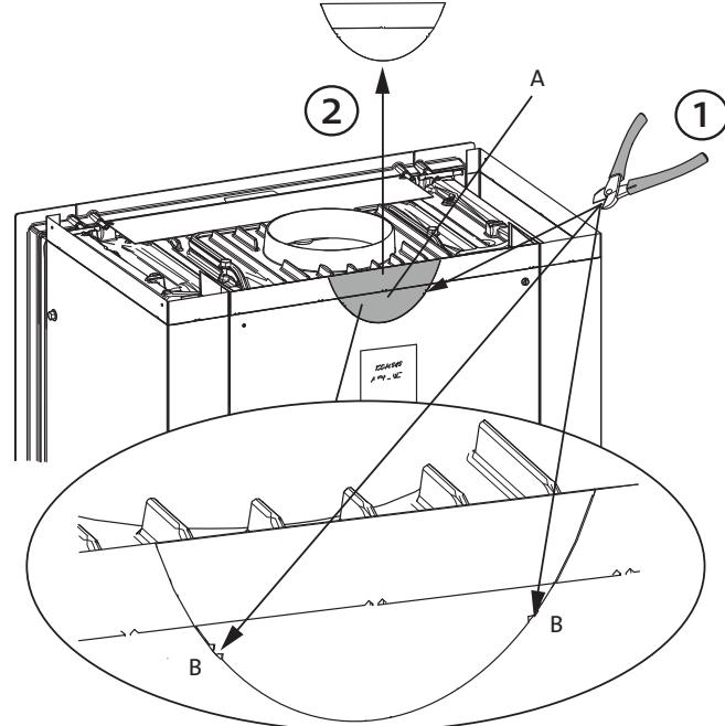
2. Si la salida de humos va en la parte posterior, tendrá que quitar la sección semicircular (A). Corte por la línea de puntos (B) y quite la sección semicircular.
