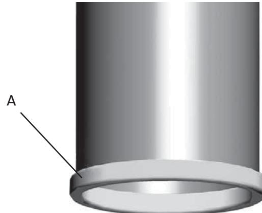
4. Inserire la guarnizione (A) sul bordo del condotto di scarico fumi.
