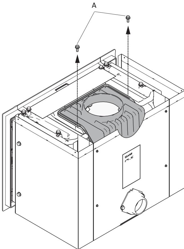
3. Extraiga los dos tornillos (**A**) que sujetan la campana de humos a la cámara de combustión.
