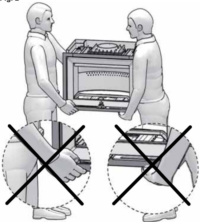
**Important! Ne pas soulever l'appareil lorsque le cadre est en place.**
