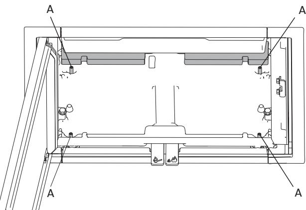
5. Con la llave Allen suministrada, ajuste los tornillos de nivelación (A) hasta que la cámara de combustión esté perfectamente nivelada y a la altura correcta.
