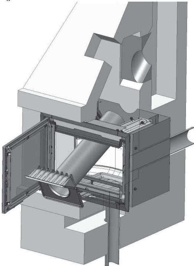
5. Fissare la campana (A) all'estremità del condotto di scarico fumi in cui è presente la guarnizione.
