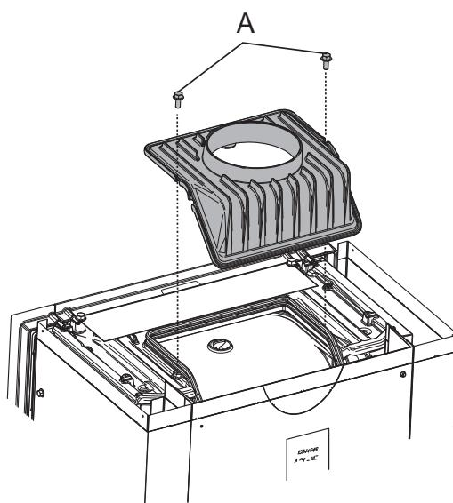
7. Retirez les deux vis (**A**) de chaque côté de la buse de raccordement et dégarez cette dernière.
