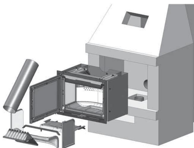
2. Antes de introducir la cámara de combustión en el hogar de obra chimenea), quite la barra sujetatroncos, las placas de combustión laterales, la placa de combustión trasera, la placa deflectora y el deflector de escape. Vuelva a colocar estos elementos una vez haya montado el tubo de chimenea y la campana de humos. Consulte las figuras siguientes.
