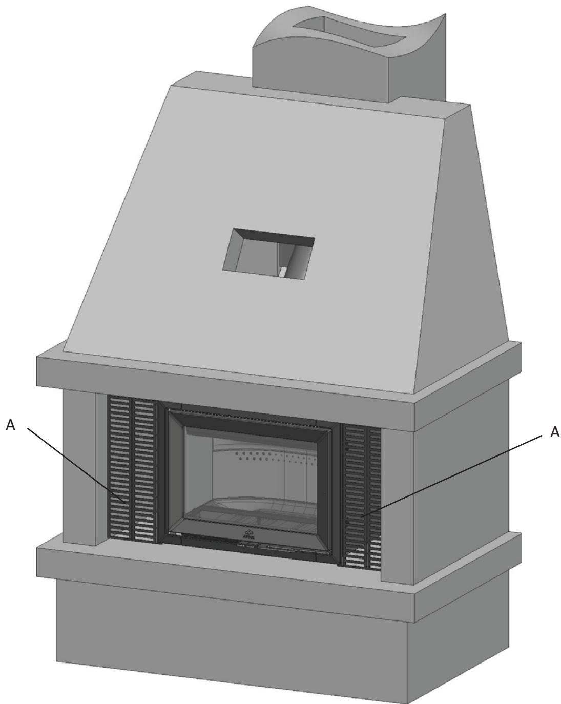
La griglia in lamina di metallo (A) deve essere tagliata su misura per il caminetto. Vedere il manuale a parte per le istruzioni sul montaggio delle griglie in lamina di metallo.
