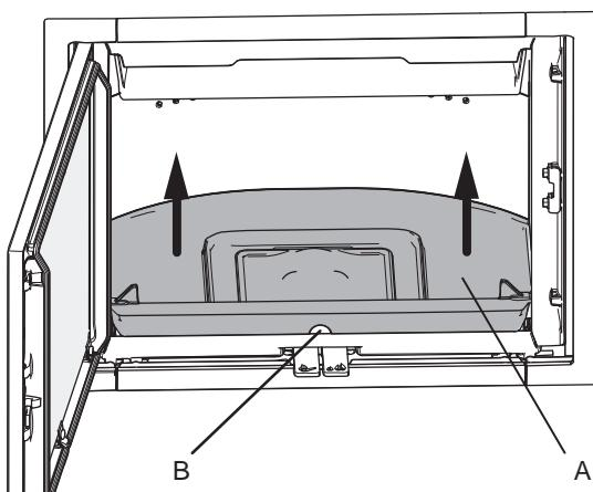
2. Fare presa sul foro (**B**) sul bordo anteriore del fondo interno (**A**) e sollevarlo.
