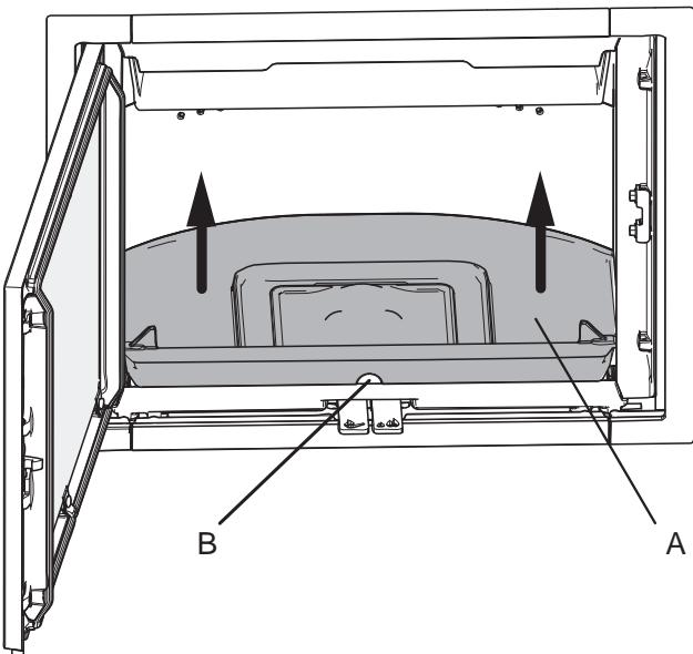
2. Fare presa sul foro (B) sul bordo anteriore del fondo interno (A) e sollevarlo.
