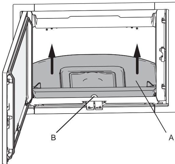
2. Sujete la placa inferior (**A**) por el orificio (**B**) del borde delantero y levántela.
