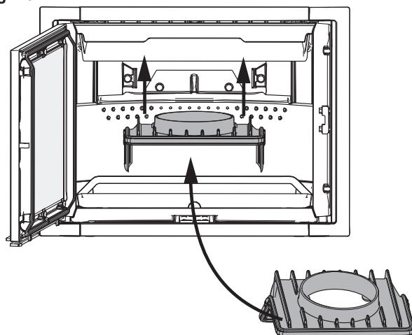
8. Fixez la buse de raccordement de l'intérieur.
