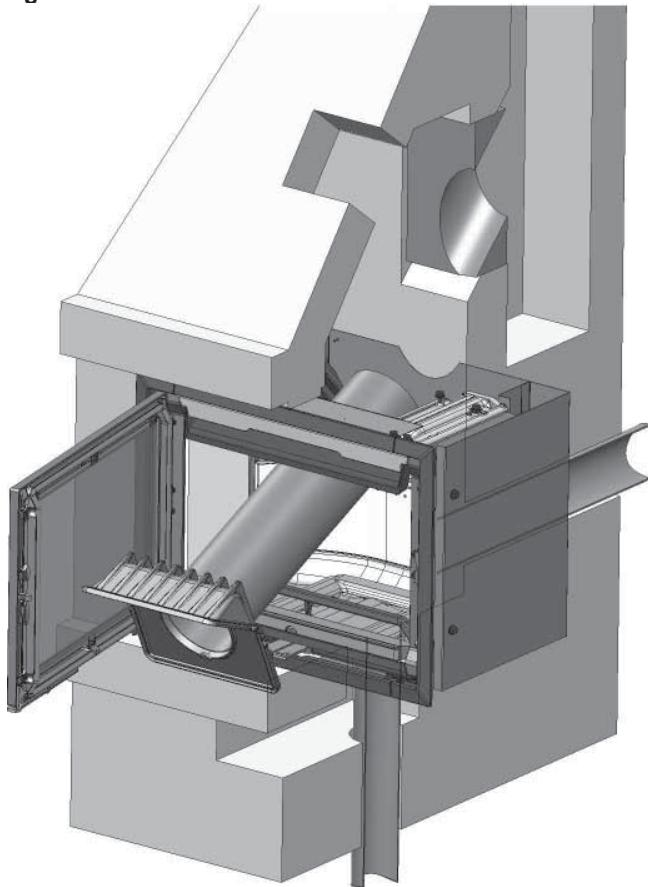
5. Fixez la boîte à fumée (**A**) à l'extrémité du conduit de raccordement, à l'endroit où le joint est monté.
