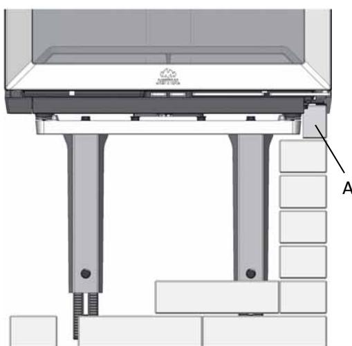
2. Découpez les dernières briques (**A**) pour qu'elles s'adaptent entre la support et le cadre. Remarque : N'oubliez pas de laisser des ouvertures dans la maçonnerie pour l'air de convection (Fig. 1 e et f).
