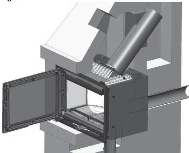
9. Passez la clé (**A**) à travers l'ouverture dans le déflecteur inférieur, la tourner et la fixer.
