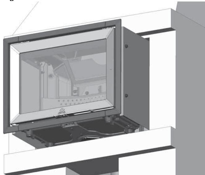
3. Far scorrere la camera di combustione sulle guide modellate sul fondo, fino a quando non è in posizione. Livellare la camera di combustione come descritto in "Livellamento dell'inserto".
