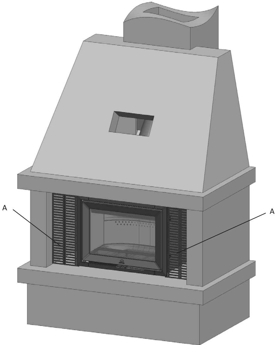
Corte la rejilla de chapa metálica (**A**) para ajustarla al hueco. Consulte en el manual correspondiente las instrucciones de instalación de la rejilla de chapa metálica.
