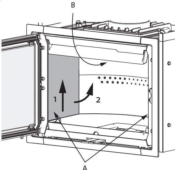
2. Extraiga una placa de combustión lateral (**A**) levantándola un poco mientras empuja el deflector (**B**) hacia arriba. Tire de la placa hacia afuera por la parte inferior y sáquela. A continuación quite la otra placa de combustión lateral del mismo modo.
