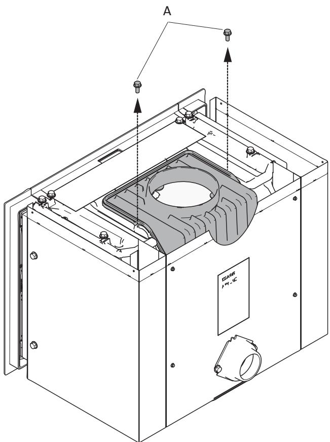
3. Retirez les deux vis (**A**) qui maintiennent la buse de raccordement sur la chambre de combustion.
