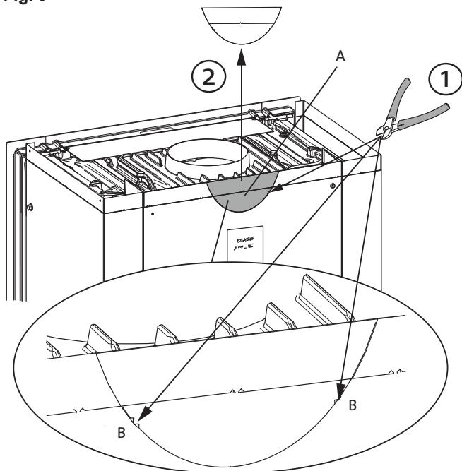
2. In caso di scarico posteriore, deve essere prima rimossa la sezione curva (**A**). Tagliare lungo i fori di estrazione (**B**). Poi spezzare la sezione estratta.
