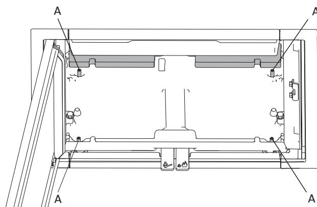
5. Utilizzare la chiave Allen in dotazione per regolare le viti di livellamento (**A**) fino a quando la camera di combustione non è a livello e all'altezza corretta.
