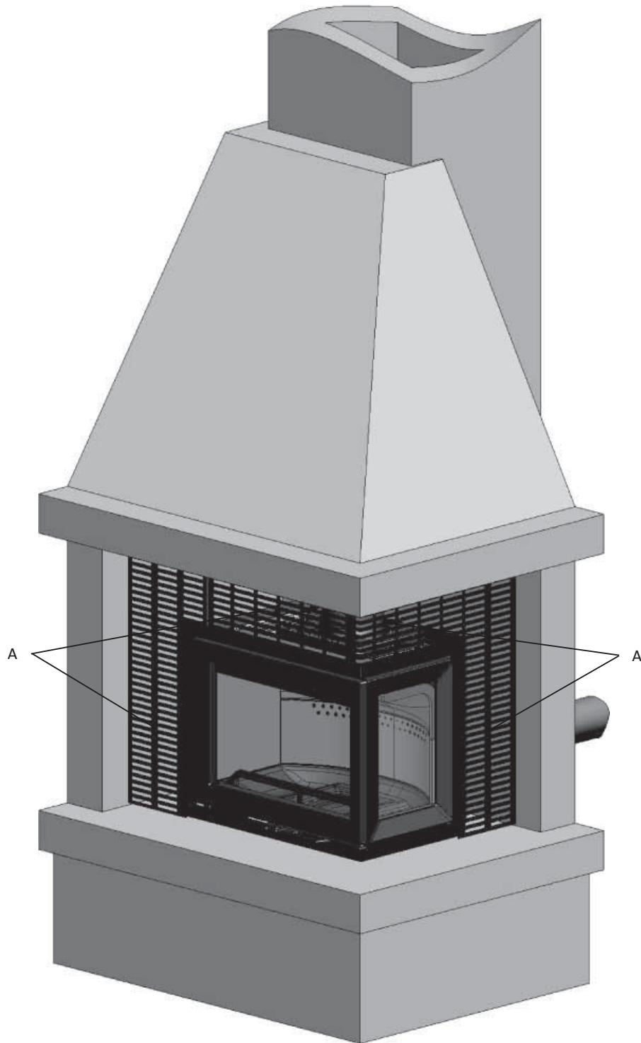
La griglia in lamina di metallo (**A**) deve essere tagliata su misura per il caminetto. Vedere il manuale a parte per le istruzioni sul montaggio delle griglie in lamina di metallo.
