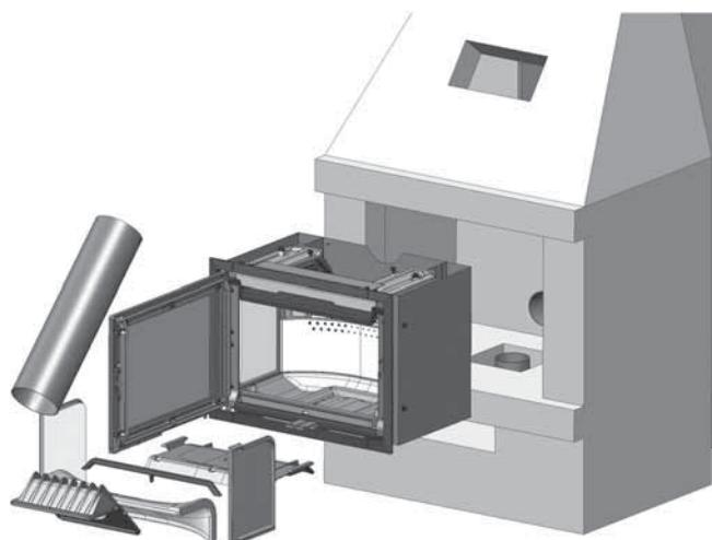
2. Prima di inserire la camera di combustione all'interno del caminetto, rimuovere il blocco dei ceppi, le piastre refrattarie laterali, la piastra refrattaria posteriore, il parafiamma e il deflettore di aspirazione. Questi vengono reintrodotti in posizione una volta che sono stati installati il condotto di scarico fumi e la campana. Vedere le figure sotto.
