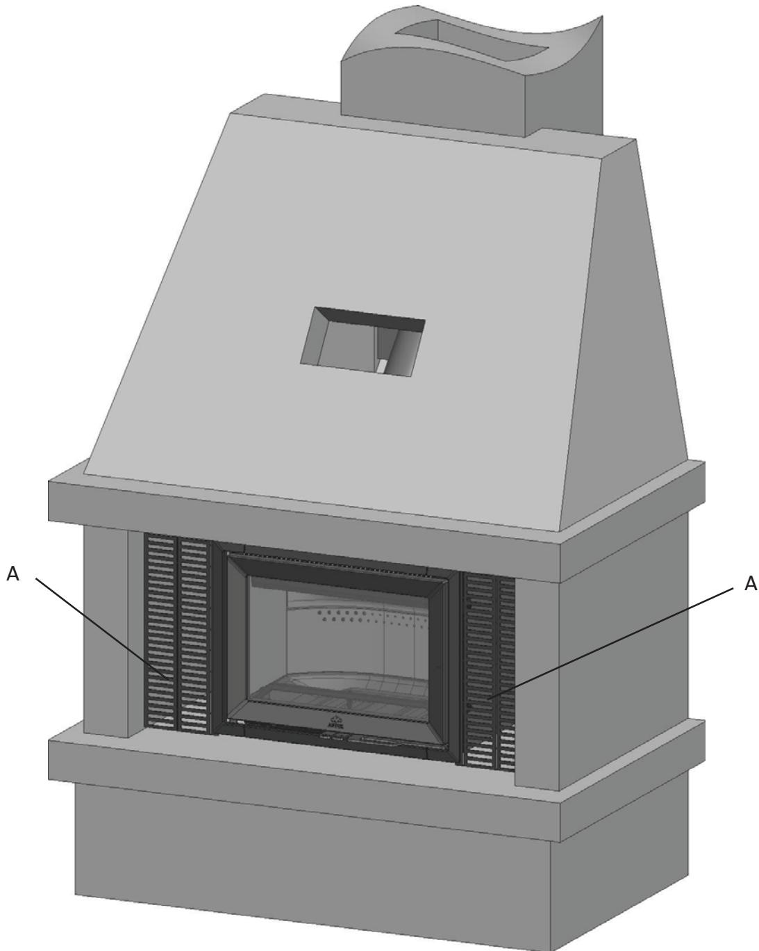
La grille métallique (**A**) doit être découpée pour s'adapter à la cheminée. Voir le manuel séparé pour les instructions sur la façon d'intégrer les treillages métalliques.
