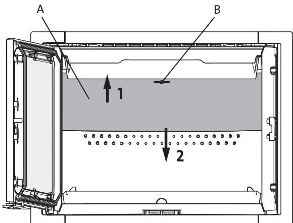
4. Empuje hacia arriba la placa deflectora (**A**). Gire la llave (**B**) 90° y extrágala. Tire hacia abajo del borde de la placa deflectora.
