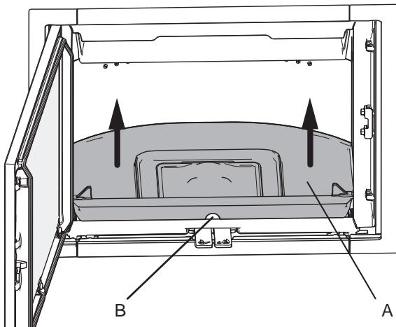
2. Sujete la placa inferior (**A**) por el orificio (**B**) del borde delantero y levántela.
