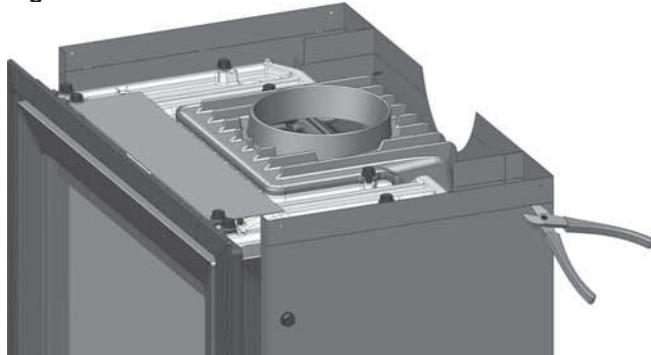
1. Tagliare lungo i fori di estrazione sopra allo scudo termico e rimuovere tale sezione.
