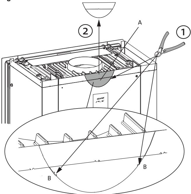
2. Si vous utilisez une sortie arrière, la section cintrée (**A**) doit être retirée en premier. Découpez les ouvertures défonçables (**B**) puis les retirer.
