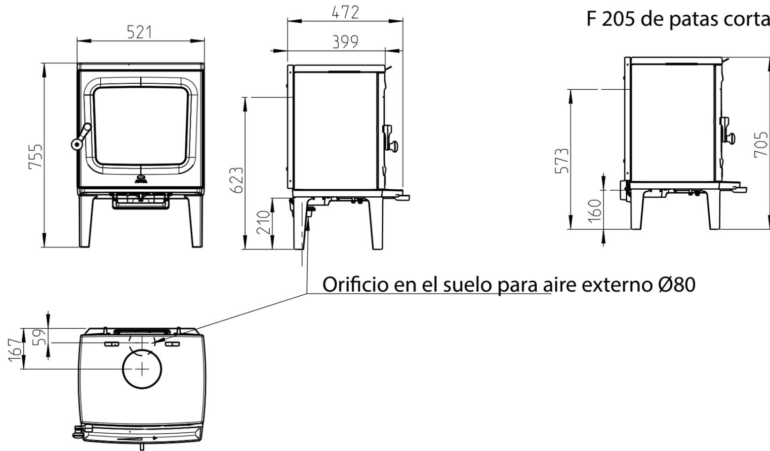
Orificio en el suelo para aire externo Ø80
